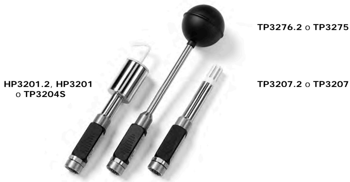
Sonde necessarie per la misura del **PMV**:
