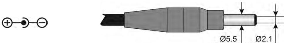
Il connettore dell'alimentatore esterno ha diametro esterno 5.5mm e diametro interno 2.1mm.
