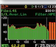
Con un microfono opzionale e l'analisi in 1/3 d'ottava o FFT SVAN 977C consente l'analisi degli **ULTRASUONI** fino a 40 kHz. I limiti dei livelli di ultrasuoni consentiti sono generalmente espressi in termini di valori Leq e Max specificati in bande di 1/3 di ottava per 20 kHz, 25 kHz, 31,5 kHz e 40 kHz.
